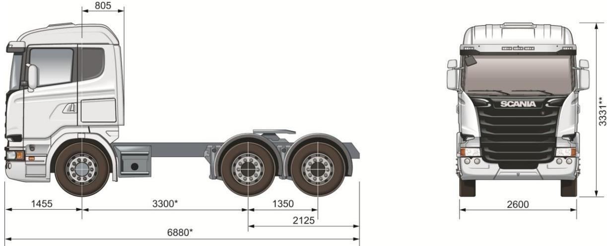
**\*\*Pode variar em função entre-eixo    \*\*Pode variar dependendo da altura do pneu e altura do chassi**
