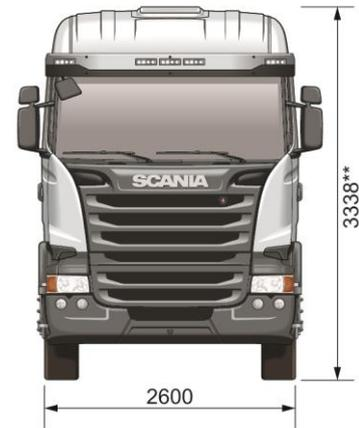
\*Pode variar em função entre-eixo \*\*Pode variar dependendo da altura do pneu e altura do chassi
