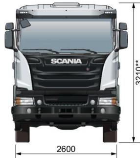
\*Pode variar em função do entre-eixo    \*\*Pode variar dependendo da altura do pneu e altura do chassi
