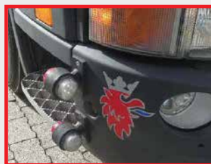
Монтирани допълнителни светлини.
