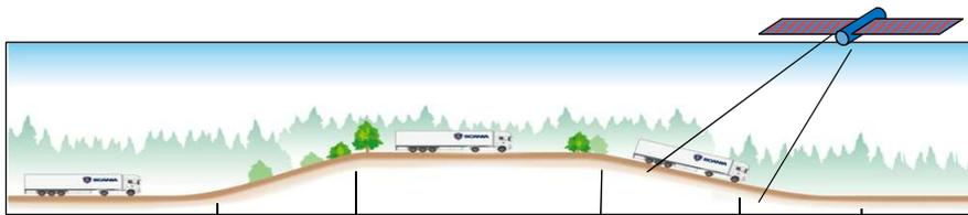
*Bei Scania CCAP erfassen Satelliten den Streckenverlauf bis 3 Kilometer vor dem Fahrzeug. Das Fahrzeug berechnet mithilfe von modernsten Algorithmen, wie es beispielsweise seine kinetische Energie nutzen kann, um bei Getriebe in Neutralstellung zu rollen.*
