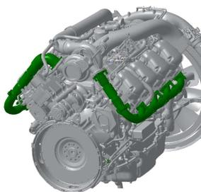
*Die neue V8-Generation von Scania setzt auf einen robusten Turbolader mit fester Turbinengeometrie (FGT), bei dem der Abgasturbolader über die grün gekennzeichneten Abgassammelrohre jeder Zylinderreihe aus zwei Richtungen gespeist wird (Twin-Scroll-Technologie).*
