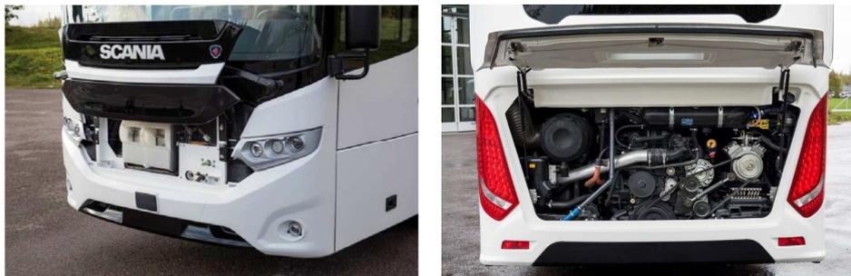
Die nach oben schwenkbare Frontklappe sorgt für leichten Zugang zu den Frontscheinwerfern, welche aus Tagfahr- und Blinkleuchten bestehen und Platz für einen zusätzlichen Weitlichtstrahler bieten. Der Frischluftfilter lässt sich, im Wartungsfall, in wenigen Minuten ersetzen.
