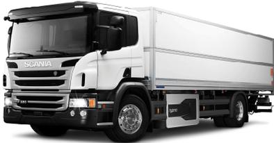
*Der schwere Hybrid-Lkw mit 320 PS der die Euro-6-Norm erfüllt, kann ausschließlich mit Strom bzw. in Verbindung mit reinem Biodiesel betrieben werden. Der modulare Antriebsstrang von Scania ist auf dem Markt einzigartig und sorgt für ein sehr gutes Fahrverhalten sowie mehr Einsatzmöglichkeiten im nächtlichen Verteilerverkehr.*
