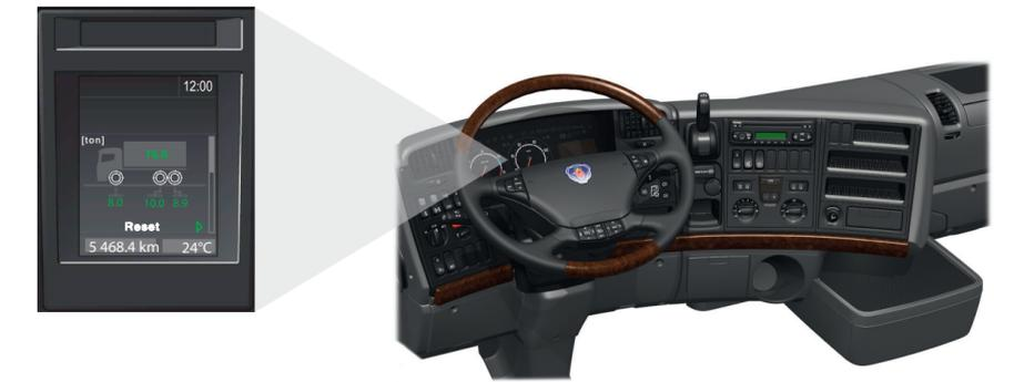
La carga sobre los ejes de suspensión neumática puede controlarse desde la cabina para transferir la carga a los ejes motrices, mejorando la fuerza de tracción; puede elevarse de la calzada cuando no hace falta.
