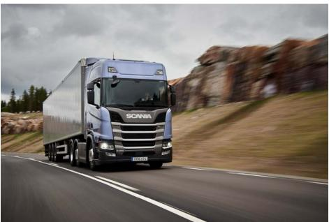
Gracias a un sistema de frenado más desarrollado, un eje delantero que se ha desplazado hacia delante y un centro de gravedad más bajo, una tractora típica de Scania con un MMA de unas 40 toneladas puede frenar desde la velocidad de crucero (80 km/h) en una distancia un 5 % más corta en condiciones normales.
