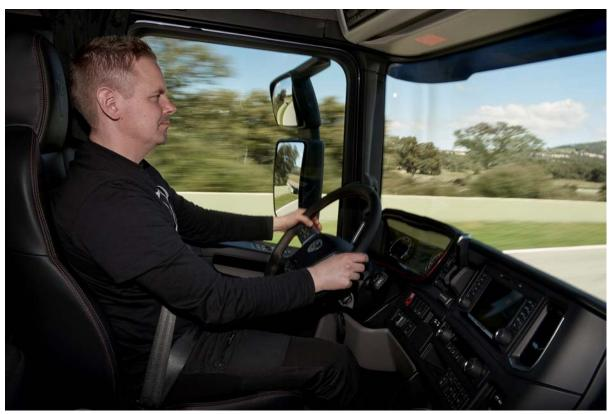
En las nuevas cabinas de Scania, la posición del conductor se ha desplazado tanto hacia delante como hacia el lateral en comparación con la gama de cabinas actual. Además de aumentar las posibilidades de ajuste del asiento, esto también permite al conductor tener una mejor visión general del entorno más próximo al camión.
