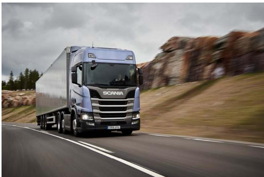
*Grazie a un sistema di frenata ancora più avanzato, a un assale anteriore che può essere spostato ulteriormente in avanti e a un centro di gravità ribassato, un tipico veicolo Scania con massa totale di 40 tonnellate e velocità di crociera di 80 km/h può frenare, in condizioni normali, entro una distanza inferiore del 5%.*
