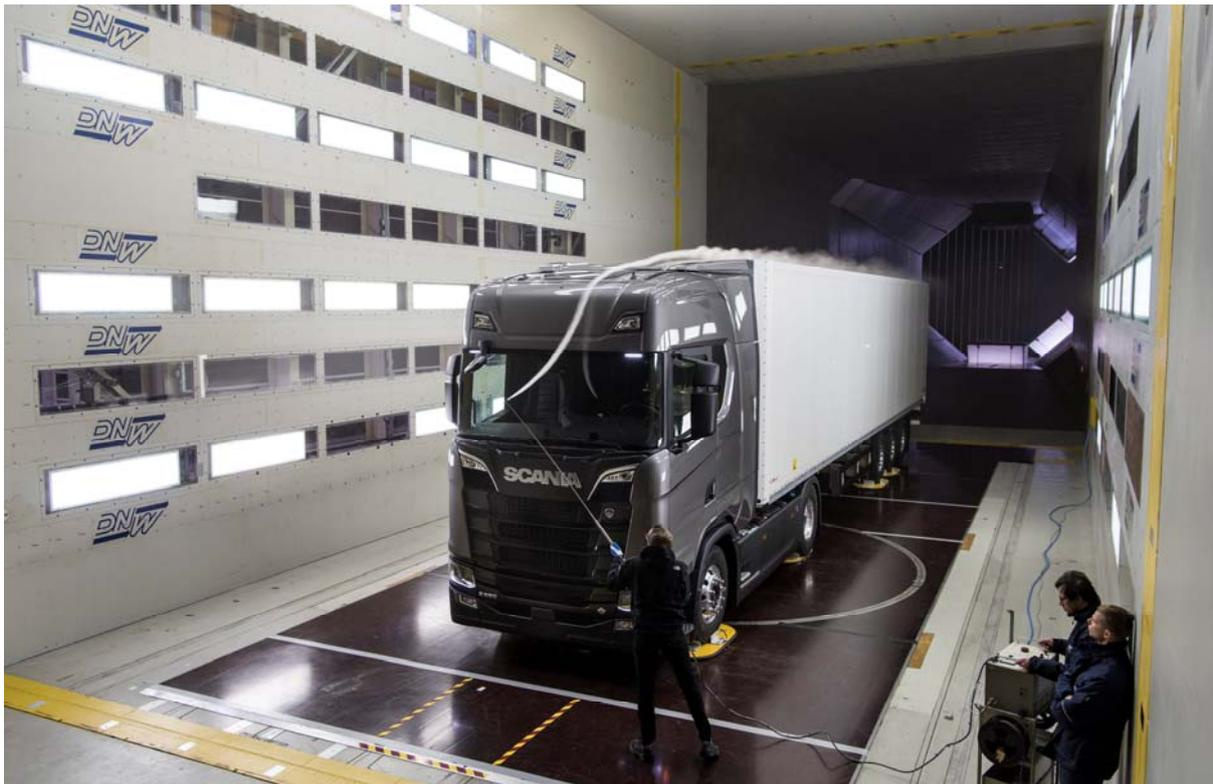
*Uno dei principali obiettivi di Scania durante lo sviluppo è stato garantire un'aerodinamica leader del settore. Sulla base delle straordinarie esperienze maturate con Scania Streamline, Scania ha realizzato un veicolo così aerodinamico che il consumo di carburante di un autocarro per il trasporto a lungo raggio può ora essere ridotto del 2% grazie a una resistenza minima all'aria.*
