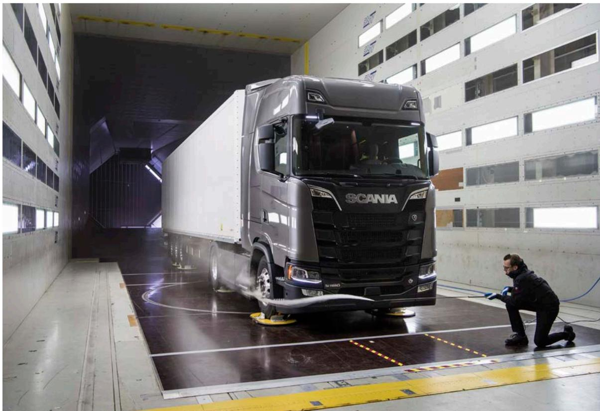
*Die neue Lkw-Generation von Scania senkt den Kraftstoffverbrauch um durchschnittlich 5 Prozent – dank weiterentwickelter Antriebsstränge und modernster Aerodynamiklösungen.*
