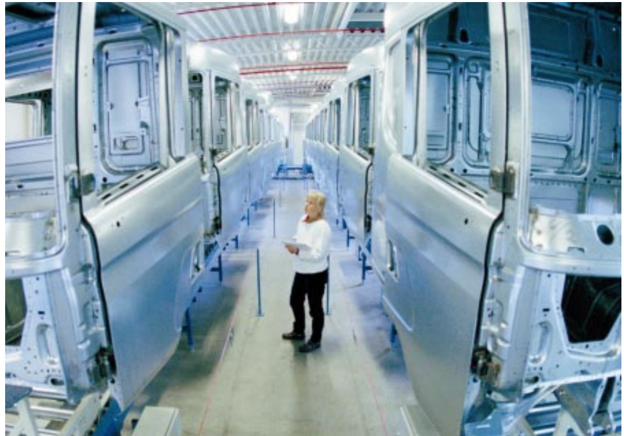
Omålade hytter på väg in till grundlackering vid Scanias nya måleri i Oskarshamn. Här sker allt arbete enligt Scanias Produktionssystem.
