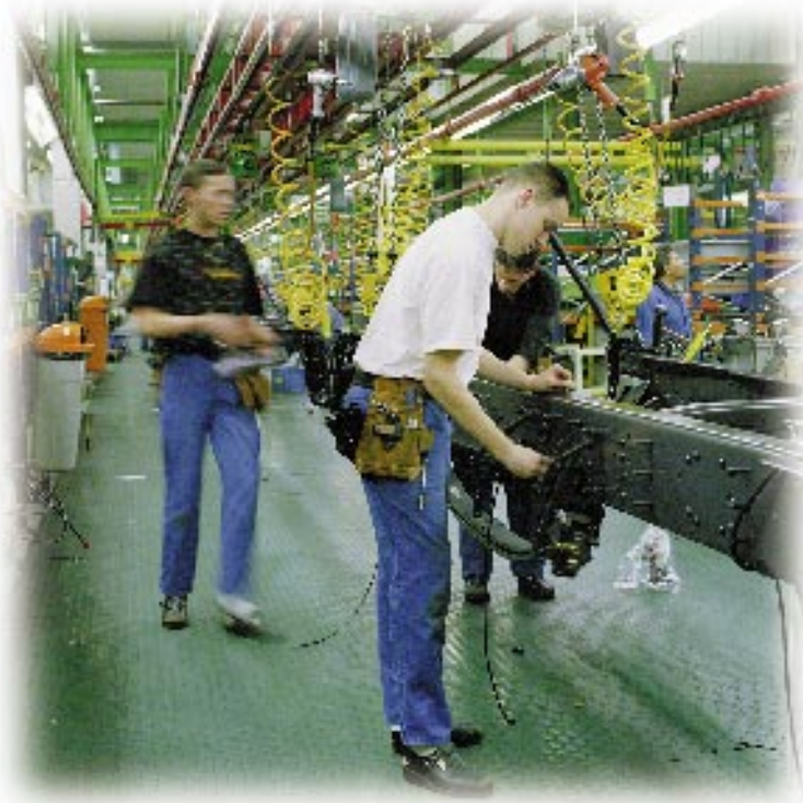
Montering av lastbilar i fabriken i Zwolle, Nederländerna.
